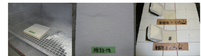
養生状況 養生後 付着力試験結果
